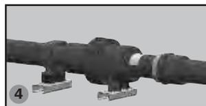
Créer le point fixe sur un support rigide à l'autre extrémité de la longueur et retirer le témoin de pose.
