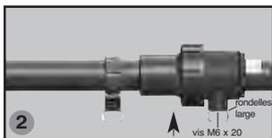
Appliquer le polymère de soudure sans excès sur toute l'emboîture femelle du HCOMP ainsi que sur le tube, procéder à l'emboîtement puis brider l'ensemble grâce aux inserts M6.
