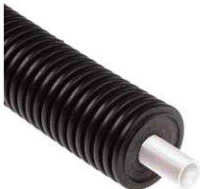
Système de canalisation pré-isolée, très flexible, avec tube caloporteur simple, principalement utilisé pour le transport de l'eau chaude sanitaire, de l'eau potable ou d'autres fluides dans des réseaux enterrés.
