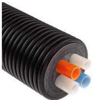
Système de canalisation pré-isolée, très flexible, combinant deux tubes chauffage et deux tubes sanitaires dans la même gaine extérieure, principalement utilisé pour le transport de l'eau de chauffage et de l'eau chaude sanitaire dans des réseaux enterrés permettant de relier la production de chaleur à ses points d'utilisation.
