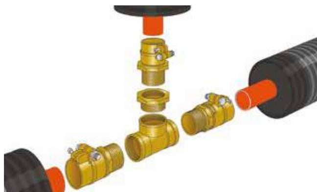
**Exemple de raccordement d'un té PER x PER x PER**
