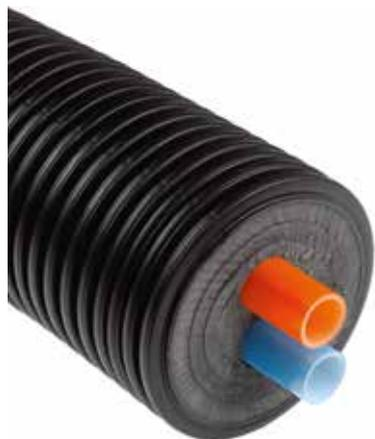
Système de canalisation pré-isolée, très flexible, comportant deux tubes caloporteurs (aller et retour) dans la même gaine extérieure, principalement utilisé pour le transport de l'eau de chauffage, de l'eau chaude sanitaire ou d'autres fluides dans des réseaux enterrés.
