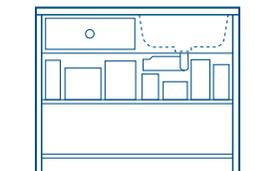
Armoire d'évier avec HepVo installé horizontalement
