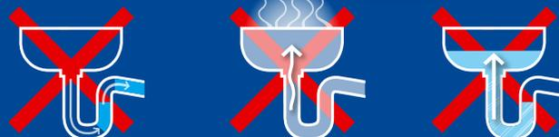
Le coupe-odeur HepVo est utilisé pour résoudre des problèmes au niveau d'installations existantes dont les siphons ne fonctionnent pas de façon optimale et causent des nuisances olfactives et sonores. HepVo offre également une solution idéale pour les appareils sanitaires qui ne sont pas utilisés pendant des périodes prolongées. HepVo est plus efficace qu'un siphon ordinaire, surtout en termes d'économie de temps.
