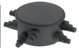
La chambre d'inspection souterraine comporte 6 orifices d'entrée possibles pour le raccordement de canalisations pré-isolées simples, doubles ou quadruples. La boîte de jonction permet également l'intégration de vannes d'arrêt. Ce kit complet est livré avec son couvercle, du mastic colle, un joint torique, des boulons, écrous, rondelles en acier inoxydable et une notice d'installation.
