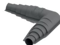
Ce kit d'isolation en PEHD assure une isolation et une parfaite étanchéité dans le raccordement en L de canalisations enterrées simples, doubles, ou quadruples. Ce kit est livré avec son isolation en laine minérale, du mastic colle, des boulons, écrous, rondelles, plaques en acier inoxydable et une notice d'installation.
