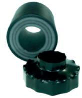
Les adaptateurs de réduction sont utilisés pour intégrer des tubes pré-isolés de plus petit diamètres dans de plus grands orifices d'entrée de kits d'isolation. L'adaptateur de réduction est inséré dans le kit d'isolation et la jonction et l'étanchéité entre l'adaptateur et le tube pré-isolé sont réalisées par un manchon thermorétractable fourni avec adaptateur.
