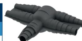
Ce kit d'isolation en PEHD assure une isolation et une parfaite étanchéité dans le raccordement en double T de canalisations enterrées pré-isolées simples, doubles, ou quadruples. Ce kit est livré avec son isolation en laine minérale, du mastic colle, des boulons, écrous, rondelles, plaques en acier inoxydable et une notice d'installation.
